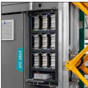
Höchste Effizienz durch Speicherung der Bremsenergie in SuperCaps
